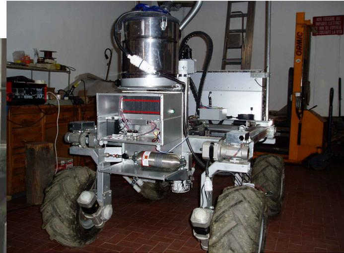
La figura in alto mostra un'applicazione di robotica realizzata da H2Planet: si tratta di un robot dedicato alla raccolta dello zafferano e ad altre attività agricole di vario tipo: in questo caso l'autonomia e la mancanza di emissioni inquinanti sono stati i fattori determinanti nella scelta della tecnologia a idrogeno.
